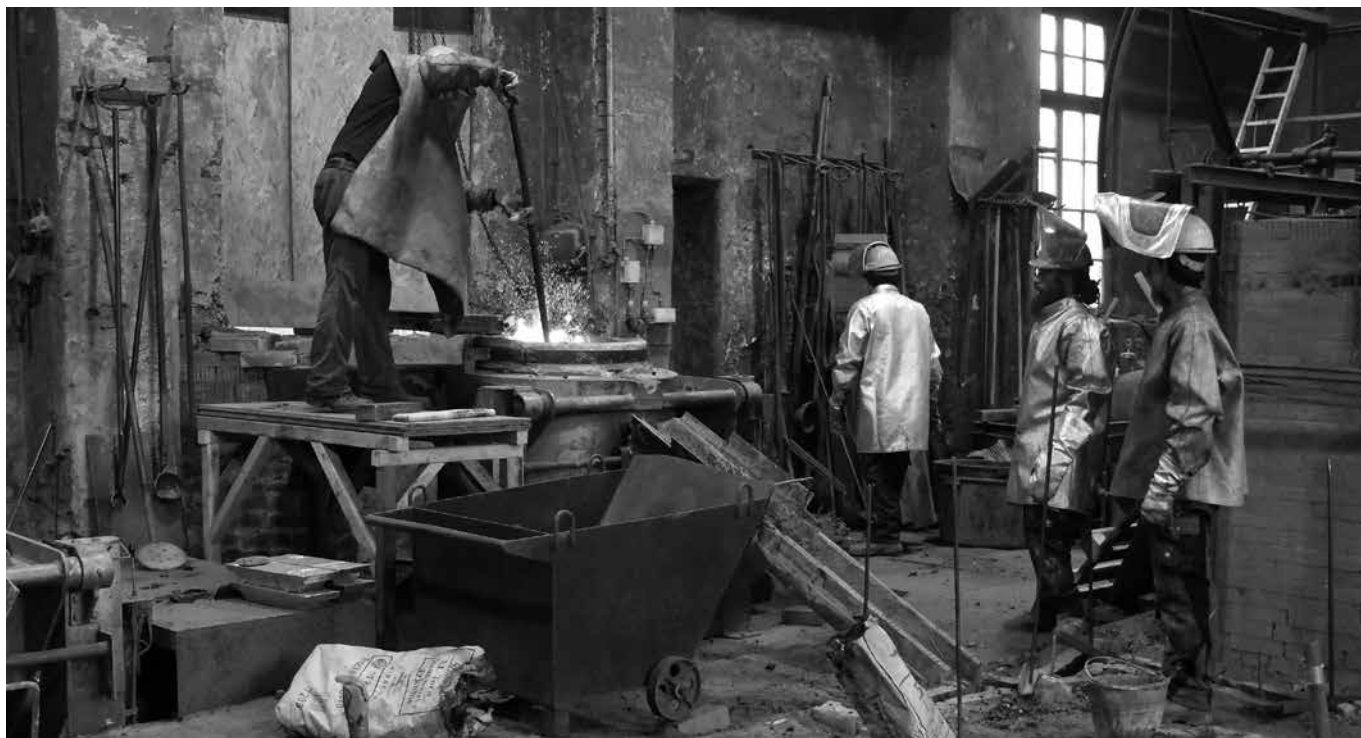
In schweißtreibender Arbeit gießen die Angestellten der Glockengießerei Perner in Passau die 25 Glocken für das Jubiläumsglockenspiel für Obertraubling. Foto Repro: Matok
