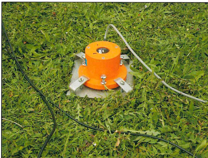
Abbildung 5: Messaufbau mit Seismometer
